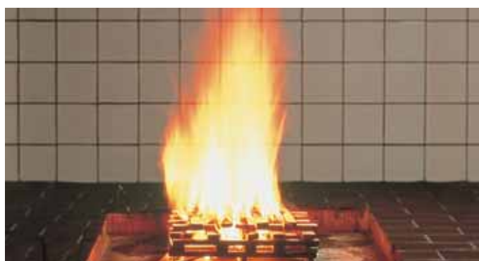
Testfeuer 1: offener Zellulosebrand (Holz)
